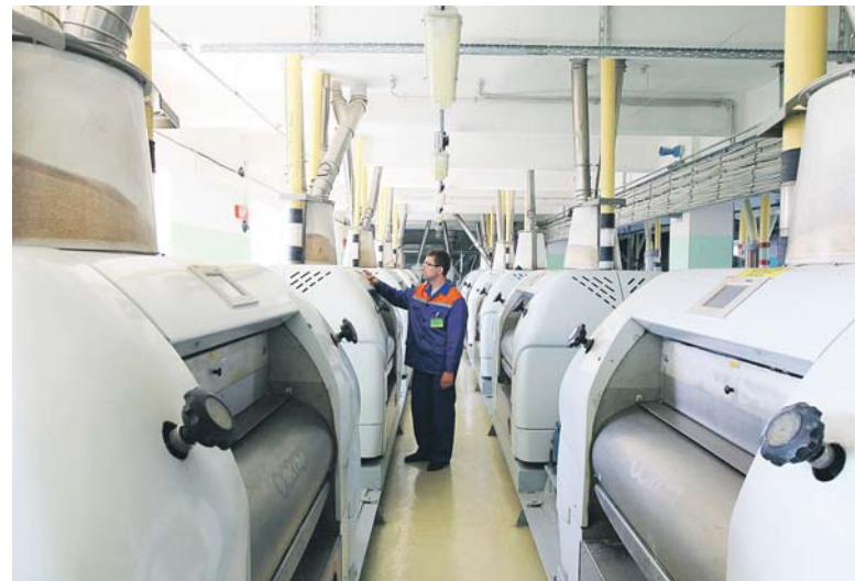
Почти дюжина вальцевых станков размольного отделения — сердце сортовой мельницы. За их бесперебойную работу отвечает Павел Васильков.
