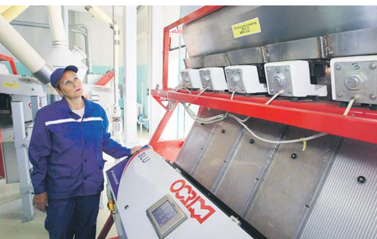
Один из самых «умных» агрегатов — оптический сортировщик зерна — доверен аппаратчику зерноочистительного отделения мукомольного производства Галине Павловце.
